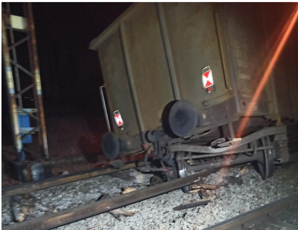
Zdjęcie 1 - Widok wykolejonego wagonu (źródło: materiały przekazane przez komisję kolejową)
